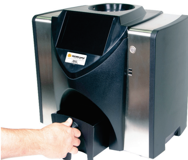
Rysunek 8 Usuwanie szuflady zbożowej
