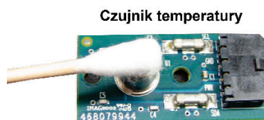
Rysunek 16 Powiększony widok właściwego czyszczenia za pomocą wacika z bawełny
