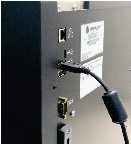
Rysunek 7 Usuwanie przewodów akcesoriów
