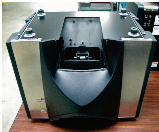
Rysunek 14 Umieść Przyrząd Do Góry Dnem
