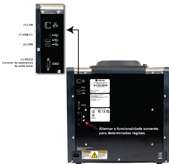
Figura 2 Conexões de comunicação externa (parte traseira da unidade)
