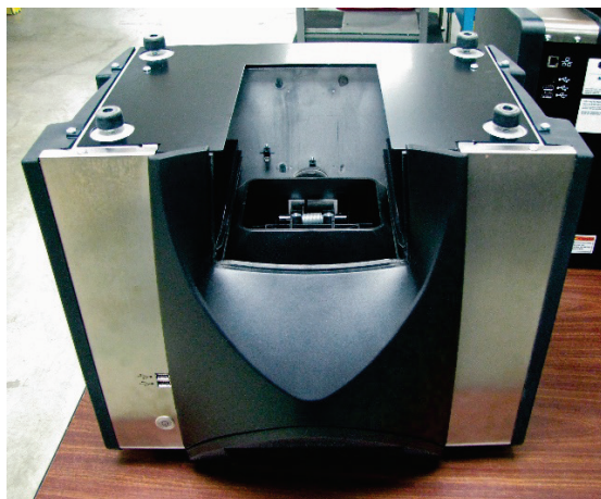
Figura 14 Coloque el instrumento boca abajo
