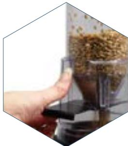
2. Ladegerät in Analysator entleeren
