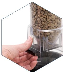
2. Vacíe el cargador en el analizador
