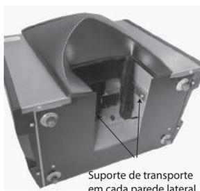
2. Remova a gaveta de grãos e posicione a unidade sobre a parte traseira para localizar os suportes de transporte nas paredes dos lados esquerdo e direito. **IMPORTANTE: Tenha cuidado ao posicionar a unidade sobre a parte traseira para evitar danos ao interruptor de segurança.**
