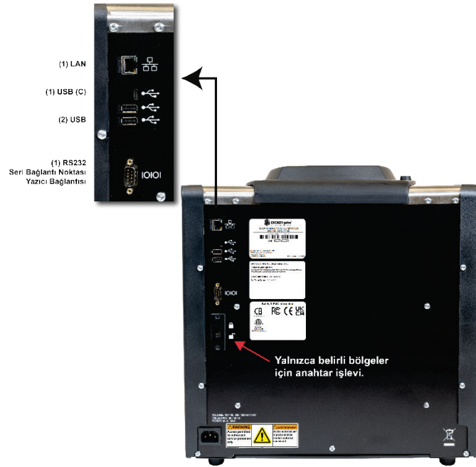
Şekil 2 Harici İletişim Bağlantıları (Birim Arka)
